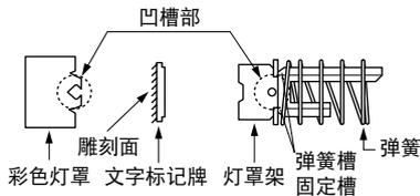
注：弹簧具有方向性，拆除后请按原样插入。(请将弹簧先端的卷起部与灯罩架的咬合槽咬合。)文字标记牌的雕刻面有上图所示的方向性。
