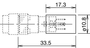
注：接线时，请先将导线插入绝缘端子罩的孔中后，再焊接。
