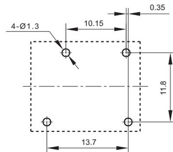
备注: (1) 产品部分外形尺寸未注尺寸公差, 当外形尺寸 $\leq 1\text{mm}$ , 公差为 $\pm 0.2\text{mm}$ ; 当外形尺寸在 $1 \sim 5\text{mm}$ 之间时, 公差为 $\pm 0.3\text{mm}$ ; 当外形尺寸 $> 5\text{mm}$ , 公差为 $\pm 0.4\text{mm}$ ;
