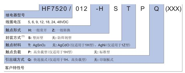
备注: (1) 在含H2S、SO2、NO2等有害气体的环境下,建议选用塑封型产品,并请在实际使用中进行试验确认;当不需要整体清洗时,建议优先选用防焊剂型产品。当继电器装入PCB板后,如需进行整体清洗,请与我司联系确认,以便提供合适的产品。 (2) 若使用于105°C环境温度,请选用防焊剂型的高负载型产品,并请在订货时特殊注明。
